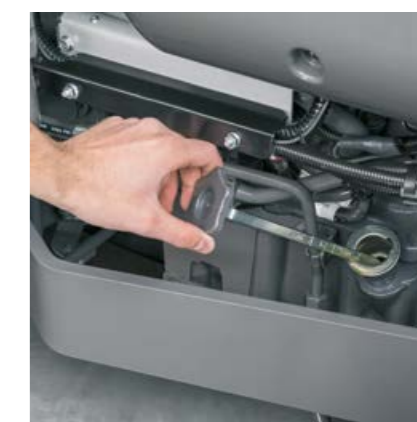
Preverjanje ravni olja in dolivanje olja pri zaprtem pokrovu na desni strani modela ELIOS 300.
