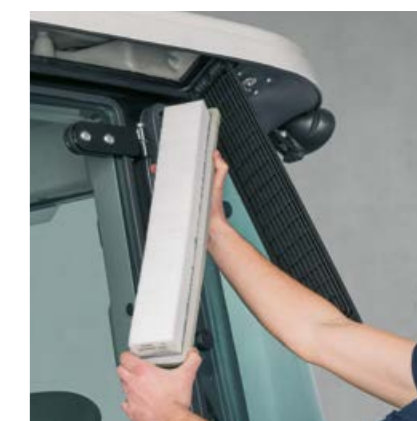
Zračni filter v kabini je zlahka dostopen za čiščenje od zunaj in vedno zagotavlja svež zrak v kabini.
