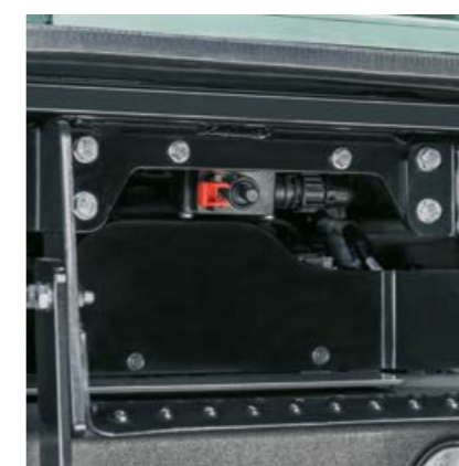
Stikalo za odklop akumulatorja je priročno nameščeno na levi strani stopnic.
