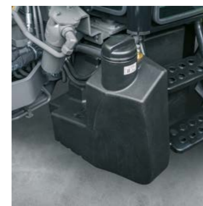
Rezervoar za gorivo 105 l in 10 l rezervoar za sečnino sta dovolj velika za dolge in naporne delovne dni.
