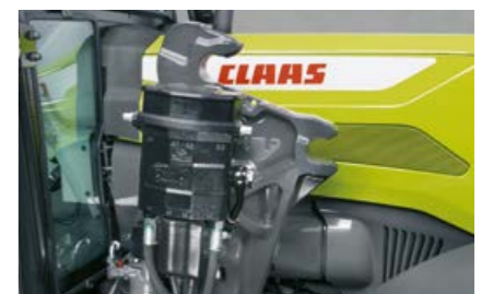
Sistem FITLOCK za priklop in odklop ter hitra spojka MACH za električne in hidravlične povezave.
