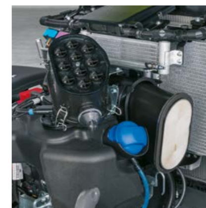
Zračni filter PowerCore® je dobro dostopen spredaj pod pokrovom motorja in zmanjša intervale čiščenja.
