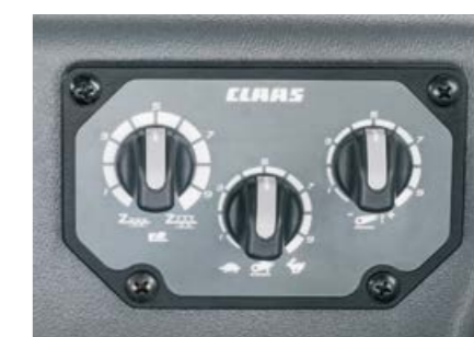
Regulacija vlečne sile, hitrost spusta in omejitev dviga enostavno nastavljate na desni konzoli.
