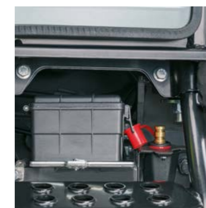
ELIOS 300 vam olajša vsakdanje življenje s številnimi inteligentnimi rešitvami, kot sta na primer zamaknjena pola akumulatorja na desni strani kabine.
