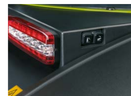
Zadnje hidravlično dvigalo lahko zunanje upravljate prek obeh zadnjih hidravličnih dvigal.
