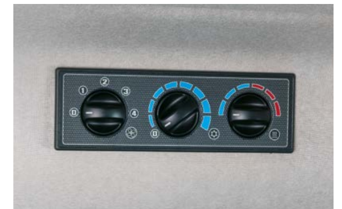
Upravljanje prezračevalnega sistema je enostavno dostopno na desni strani v stropu.
