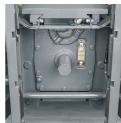
Nivo olja menjalnika in hidravlike lahko preverite v kontrolnem okencu ob koncu zadnje kardanske gredi.
